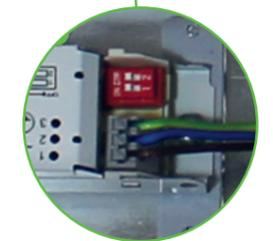
Osram LED-Treiber mit regelbarem Ausgangsstrom\* (Leistungsanpassung in 4 Stufen mittels DIP Schalter; 25-36W bei 1,2m-Version und 40-54W bei 1,5m-Version)
