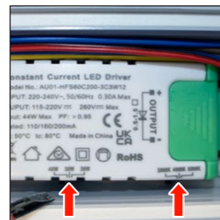
Farbwahl-/ Leistungswahlschalter CCT select/Power Select switch
