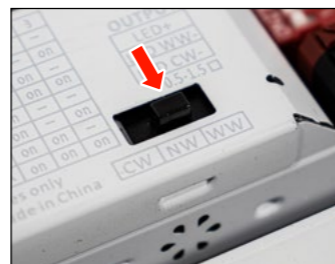
Farbwahlschalter für 3 Lichtfarben CCT selector for 3 light colours
