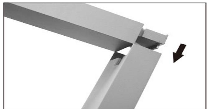
Abb. 6: Winkelstück des Kopfes in die Säule schieben
